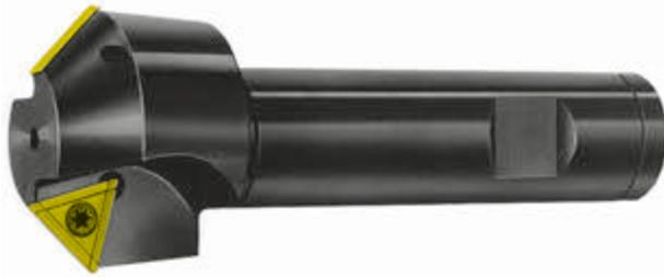
Vielseitiges Werkzeug, für Senkungen nach DIN 74 Blatt1 Form A fein, sowie zum Abkant- und Zirkularfräsen. Stabile Maschinenverhältnisse Voraussetzung.
