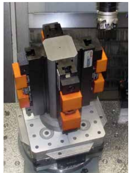
Mehrfachspannsystem MSE 260-50-1 auf Spannturm Multiple clamping system MSE 260-50-1 on a clamping tower
