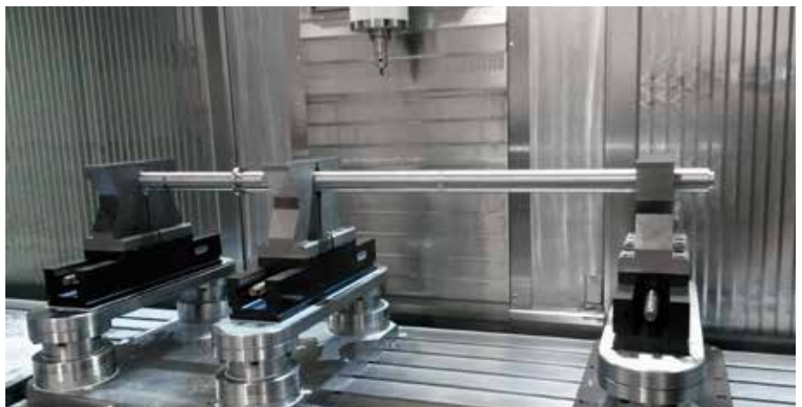
Mechanischer Zentrischspanner MZU 500-125-2 mit Prismenbacken Mechanical centre-clamping vise MZU 500-125-2 with prism jaws
