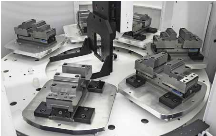
Mechanischer Zentrischspanner MZC 280-100 S auf Palettenwechsler Mechanical centre-clamping vise MZC 280-100 S on pallet changer
