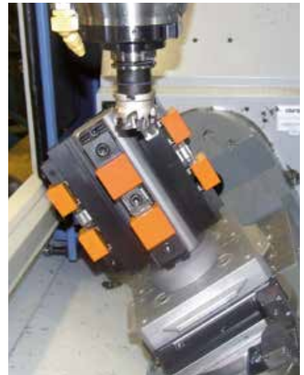
Mehrfachspannleiste MSE 260-50-1 an 90° Spannturm Multi clamping system MSE 260-50-1 on 90° clamping tower
