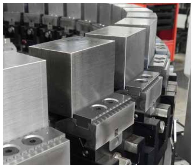
Stufen-Wendebacken mit Gripeisen Reversible stepped jaws with grip inserts
