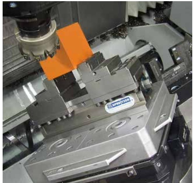
Mechanischer Zentrischspanner MZC 220-80 E auf Palette Mechanical centre-clamping vise MZC 220-80 E on a pallet
