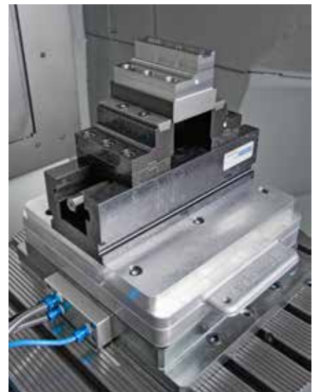
Mechanischer Zentrischspanner MZU 280-100 auf Palettiersystem Mechanical centre-clamping vise MZU 280-100 on a palletizing system
