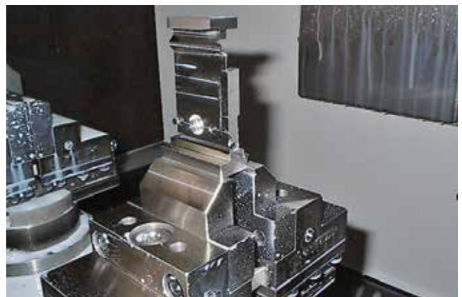
Mechanischer Zentrischspanner MZS 180-80 B mit geringer Einspanntiefe Mechanical centre-clamping vise MZS 180-80 B with close clamping
