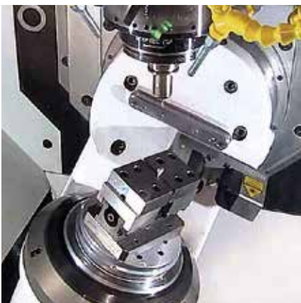
Mechanischer Zentrischspanner MZS 100-50 A auf Palette Mechanical centre-clamping vise MZS 100-50 A on pallet
