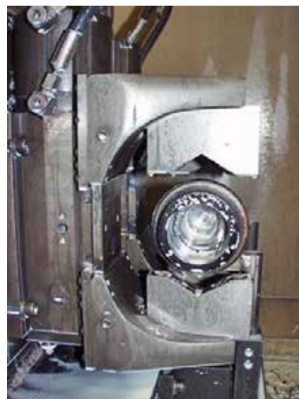
Hydraulischer Zentrischspanner HZS 250-100 D auf horizontal Bearbeitungszentrum Hydraulic centre-clamping vise HZS 250-100 D on a horizontal machining centre
