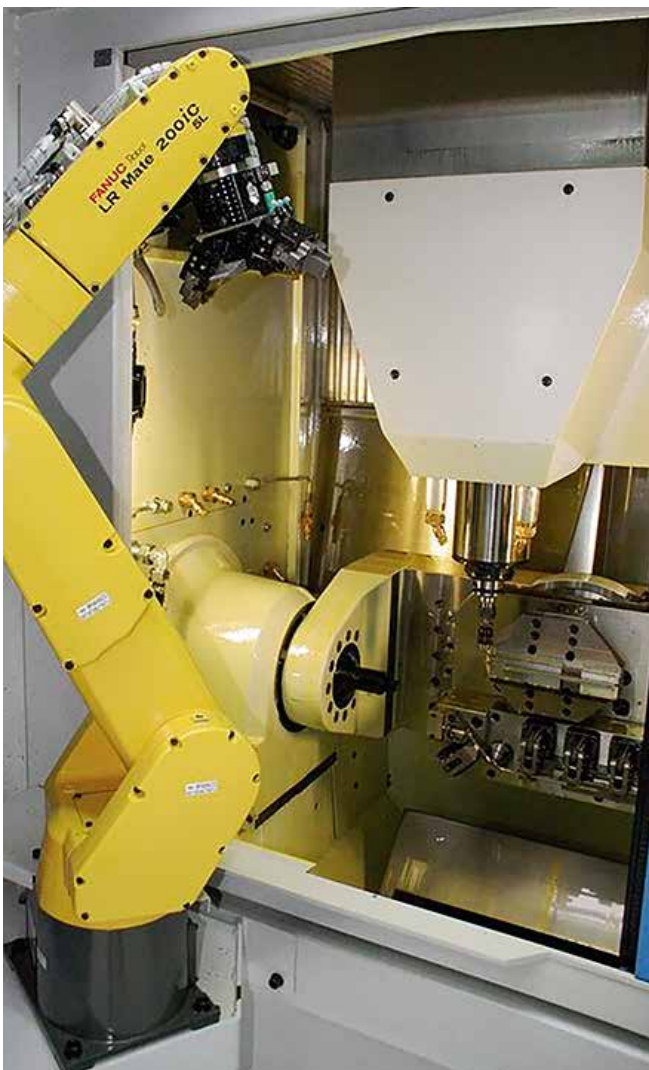
Hydraulischer Zentrischspanner HZS 180-80 in Automationszelle Hydraulic centre-clamping vise HZS 180-80 in automation cell
