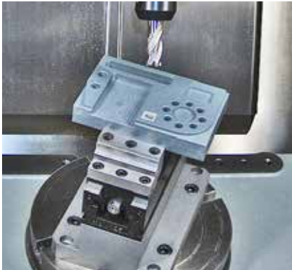
Mechanischer Zentrischspanner MZU 280-100 auf Unterbau Mechanical centre-clamping vise MZU 280-100 on a base cube
