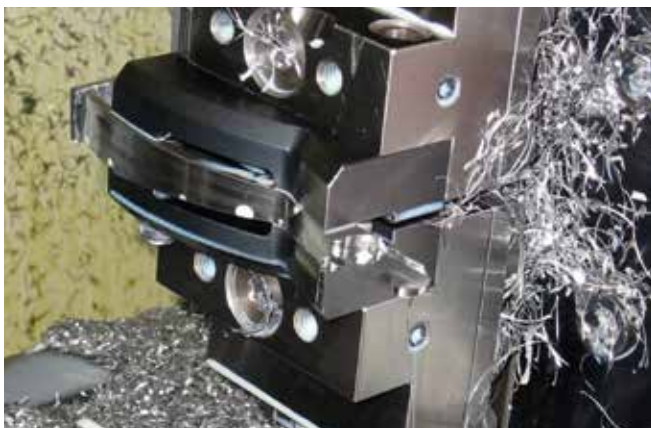
Mechanischer Zentrischspanner MZS 180-80 B mit Sonderbacken Mechanical centre-clamping vise MZS 180-80 B with custom designed jaws
