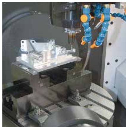
Mechanischer Zentrischspanner MZU 360-125 auf Mehrachs-Bearbeitungszentrum Mechanical centre-clamping vise MZU 360-125 on multi-axis machining centre
