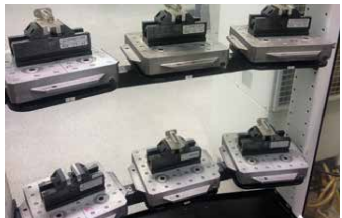
Mechanischer Zentrischspanner MZE 170-60 auf Paletten Mechanical centre-clamping vise MZE 170-60 on pallets
