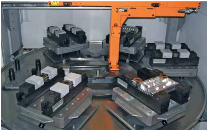
Mehrfachspannleiste MSE 260-50-1 auf Palettiersystem Multi clamping system MSE 260-50-1 on palletizing system
