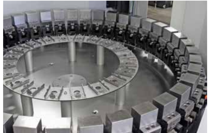
Mechanischer Zentrischspanner MZQ 110-60 auf Palettiersystem Mechanical centre-clamping vise MZQ 110-60 on a palletizing system
