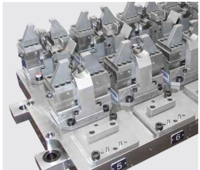
Hydraulischer Zentrischspanner HZS 180-80 A auf Wiegenplatte Hydraulic centre-clamping vises HZS 180-80 A on swivel plate
