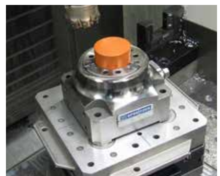
Ausführung SK-2, Werkstückspannung über Spannhülse (Innenspannung) Type SK-2, workpiece clamping via clamping sleeves (internal clamping)
