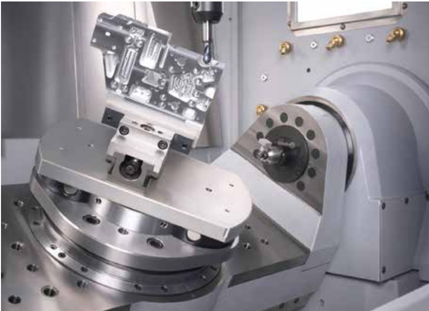
Mechanischer Zentrischspanner MZS 180-80 B auf Palette Mechanical centre-clamping vise MZS 180-80 B on a pallet
