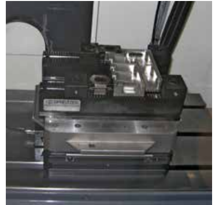
Zwei Mehrfachspannsysteme MSE 260-50-1 auf Palette Two multiple clamping systems MSE 260-50-1 on a pallet
