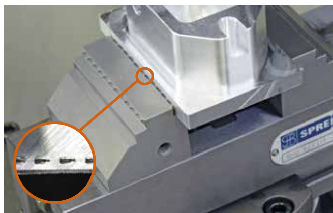
Wendebacken mit Grip (1. Aufspannung) und glatter Spannstufe (2. Aufspannung) Reversible jaws with grip (first set-up) and smooth jaw steps (second set-up)
