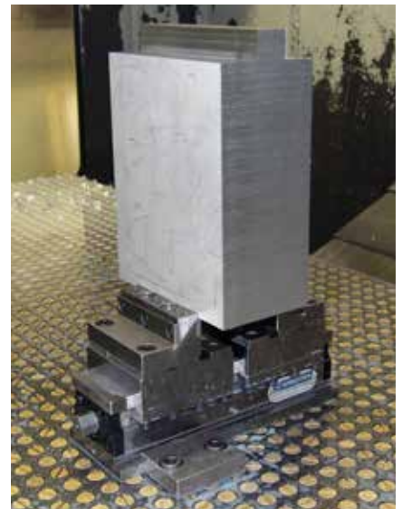
Mechanischer Zentrischspanner MZC 220-80 E, Spannbacken mit HM-Gripleisten Mechanical centre-clamping vise MZC 220-80 E, clamping jaws with carbide grip inserts
