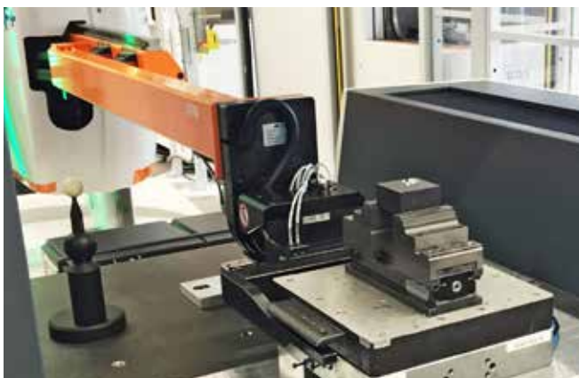
Mechanischer Zentrischspanner MZC 220-80 E auf Palettiersystem Mechanical centre-clamping vise MZC 220-80 E on a palletizing system
