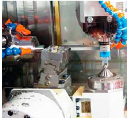
Hydraulischer Zentrischspanner HZS 120-60 A auf Mehrachs-Bearbeitungszentrum Hydraulic centre-clamping vise HZS 120-60 A on a multi-axis machining centre
